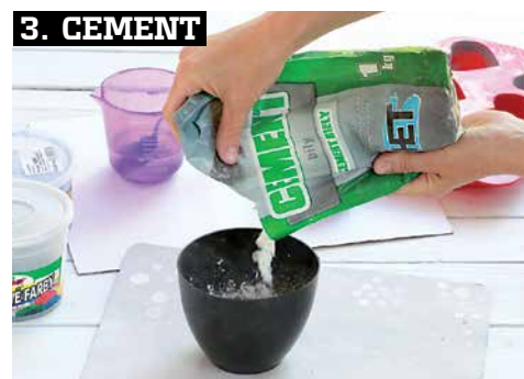
3. CEMENT Do zafarbenej vody nasypeme biely cement a vymiešame riedku kašu.
